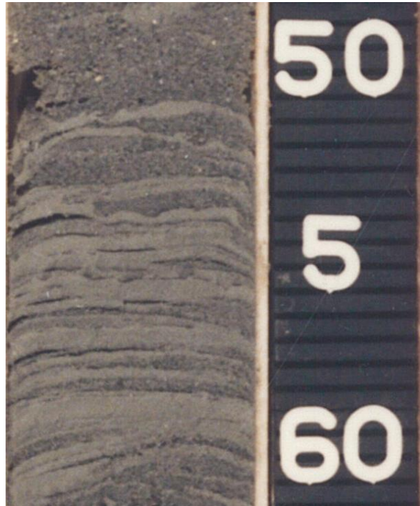
Figuur 10 Detail van een boring van de Steenbank, met een afwisseling van laagjes slib (glad, iets lichter grijs) en zand (korrelige textuur, iets donkerder grijs). Locatie ten westen van Zeeland (DINO kenmerk BS070216_00, bron Dinoloket).
