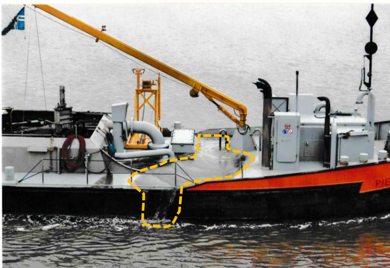
Figuur 6 Overvloei uit de beun van een kleine sleehopperzuiger (gemarkeerd door oranje-gestippelde lijn).
