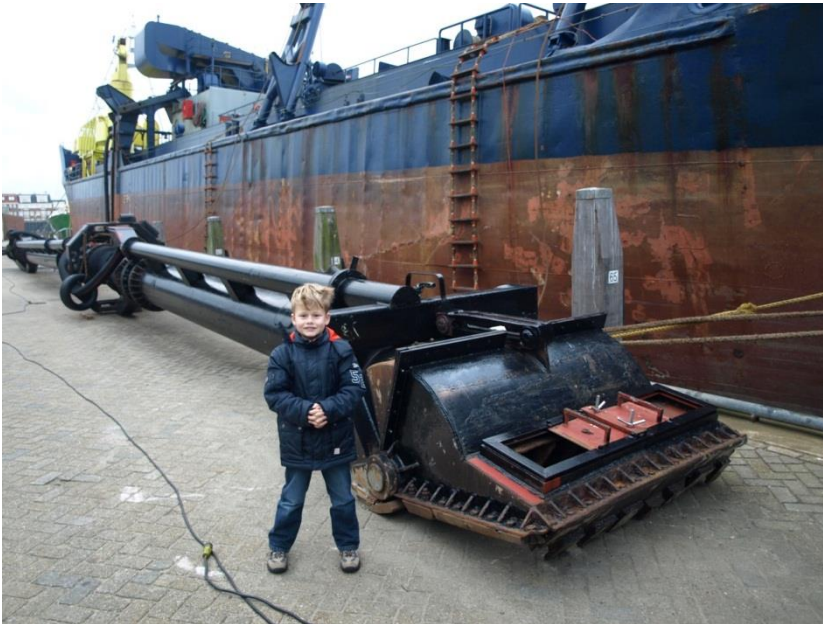
Figuur 5 Foto van de zuigkop van een sleehopperzuiger: de Interballast I aan de kade in Breskens, 23/12/2014.
