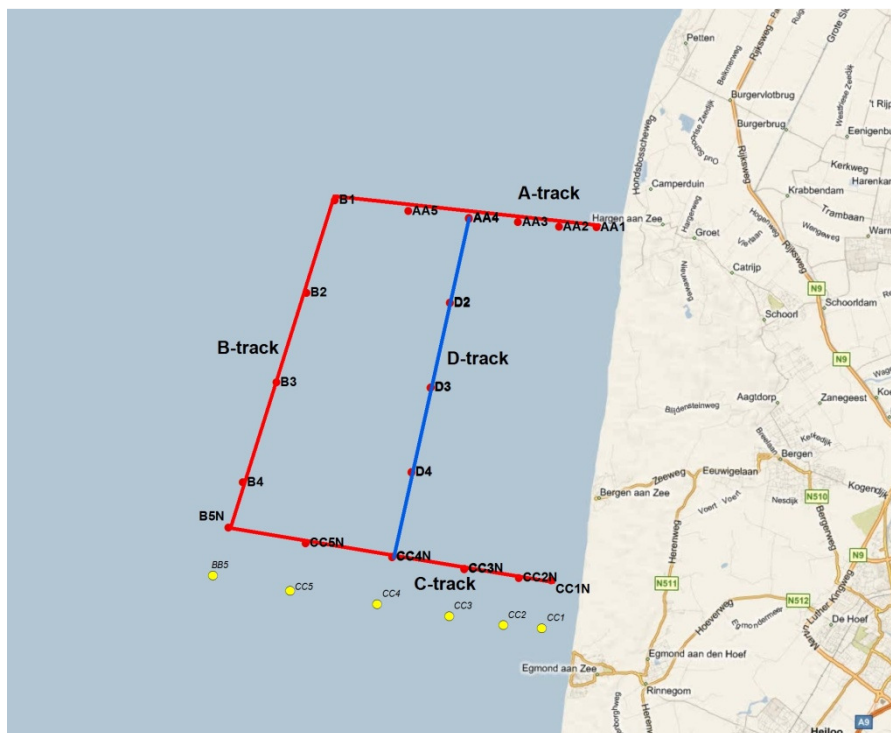
Figuur 2: overzicht van de onderzoekslijnen. De metingen zijn uitgevoerd vanuit IJmuiden. In blauw is de D-track aangegeven.
