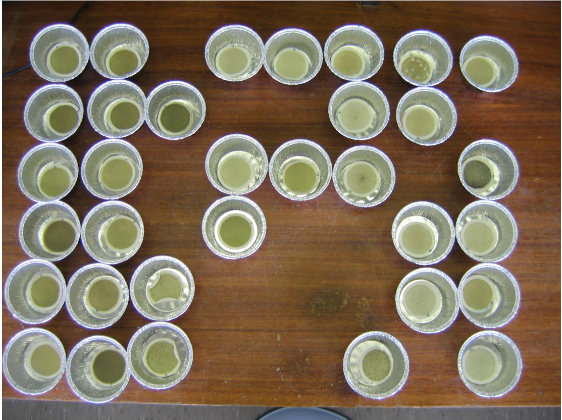
Foto 5. Afgefilterd zwevend stof na droging.
