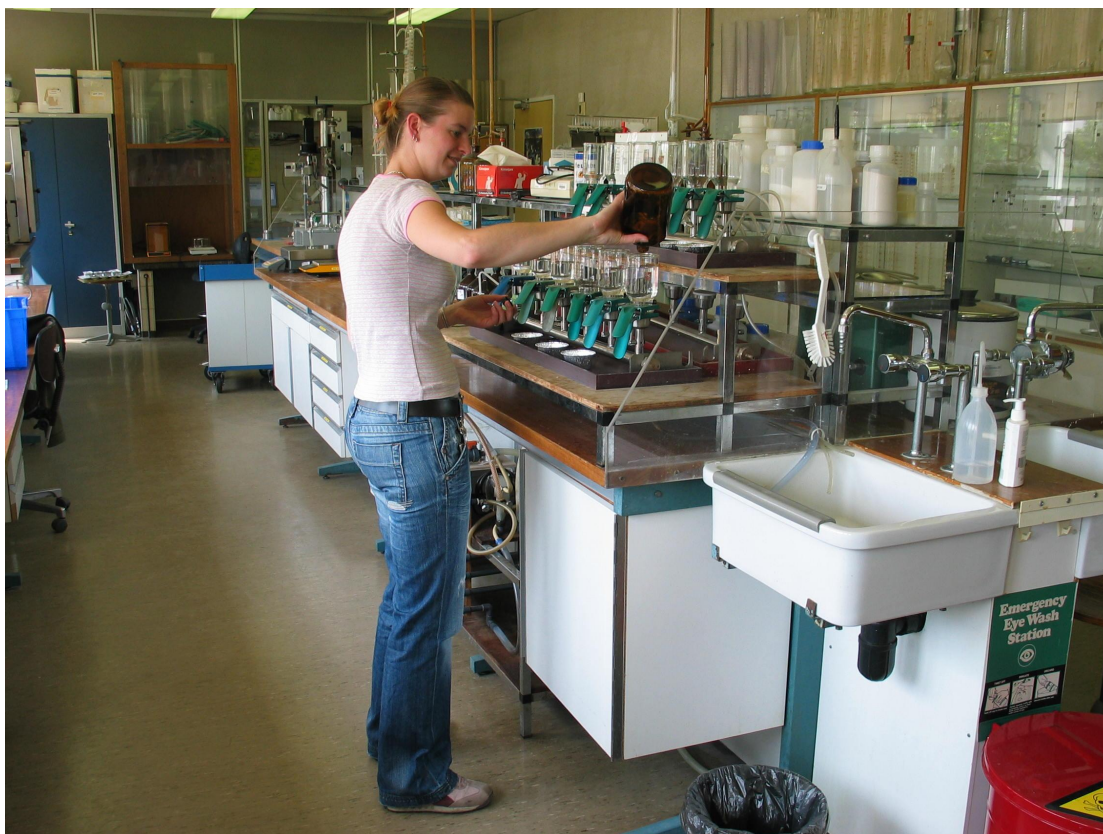
Foto 3. Regelmatig bijvullen van filtreerkeken.
