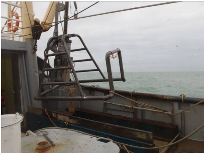
Figuur 5: De gebruikte boxcorer en opvangslede aan boord van de BRA7
