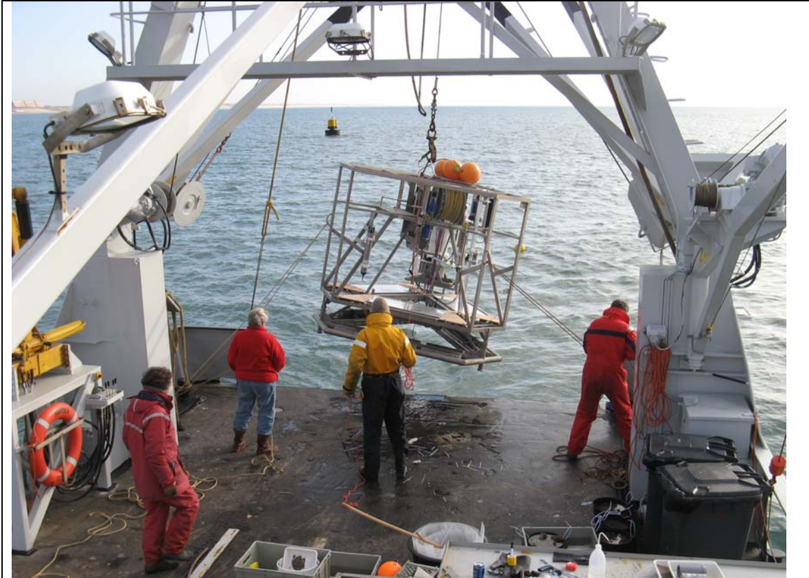
Figuur. 3. Deployment van de lander vanaf RV NAVICULA.
