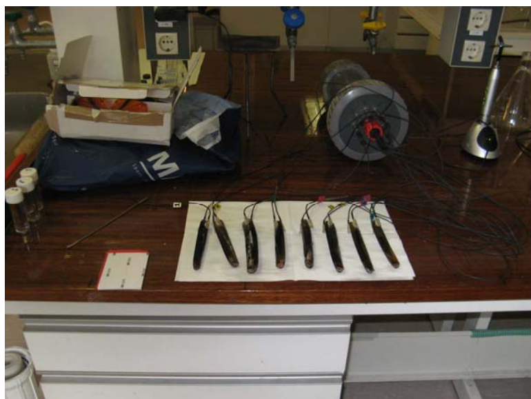
Foto 1. Acht Ensis individuen die voorzien zijn van sensoren en klaar liggen om geplaatst te worden in een experimentele opstelling.
