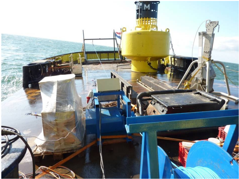
Figuur 3: kabelhaspel en lier van het Medusa-systeem. De kabel loopt via achtersteven overboord.
