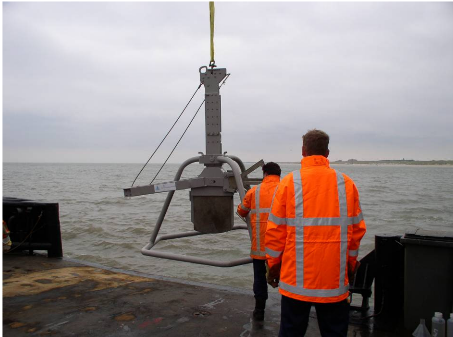
Figuur 6: de Boxcorer wordt overboord gezet.
