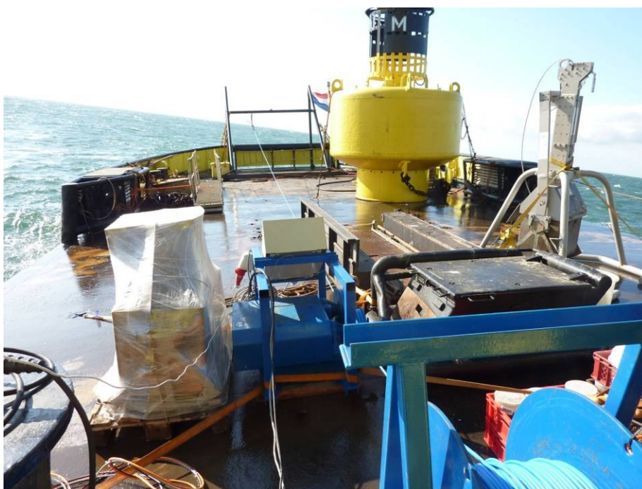
Figuur 3: kabelhaspel en lier van het Medusa-systeem. De kabel loopt via achtersteven overboord.
