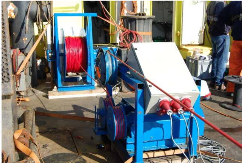
Figuur 1: kabelhaspel en lier van het Medusa-systeem. De kabel loopt via de achtersteven overboord.
