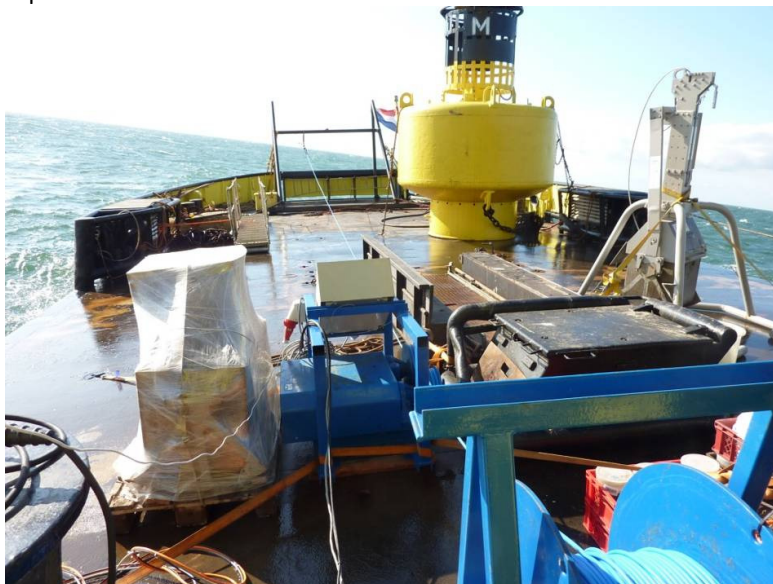
Figuur 2: kabelhaspel en lier van het Medusa-systeem. De kabel loopt via achtersteven overboord.
