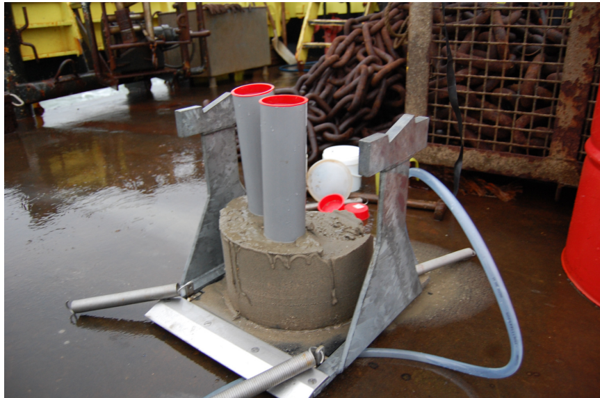
Figuur 1: een zojuist genomen kern uit de boxcorer.
