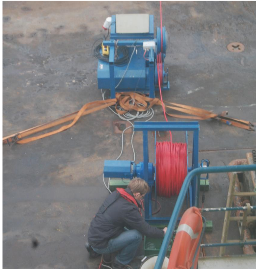
Figuur 2: kabelhaspel en lier van het Medusa-systeem. De kabel loopt via de achterstevan overboord.
