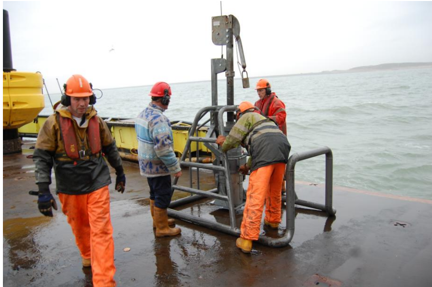
Figuur 1: de boxcorer.
