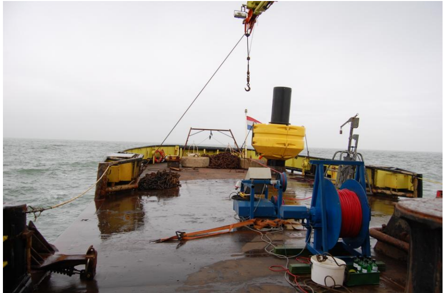
Figuur 2: kabelhaspel en lier van het Medusa-systeem. De kabel loopt via de achtersteven overboord.
