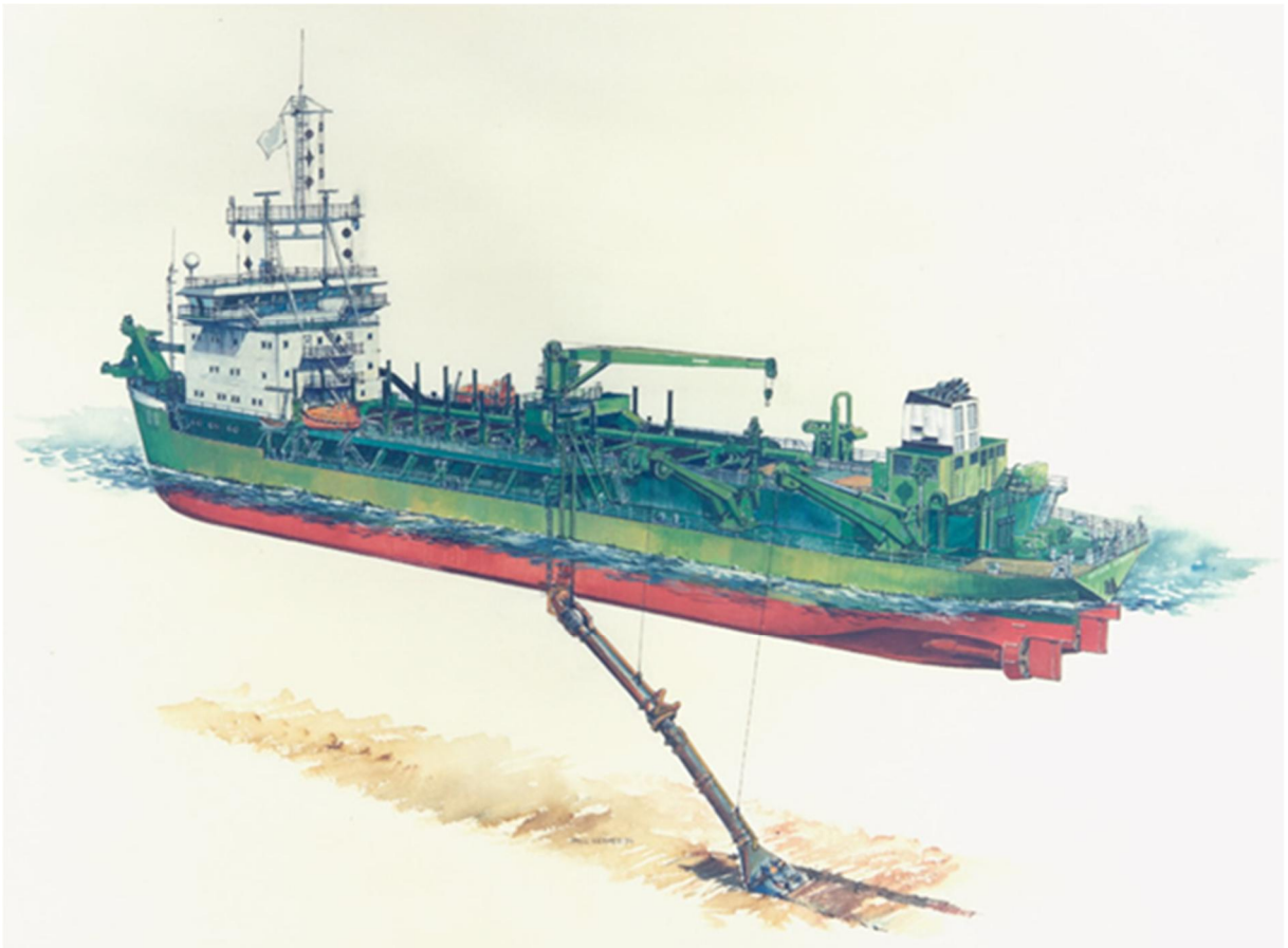
Figuur 5.2 Afbeelding van een slephopperzuiger (Bron: edugis.nl)
