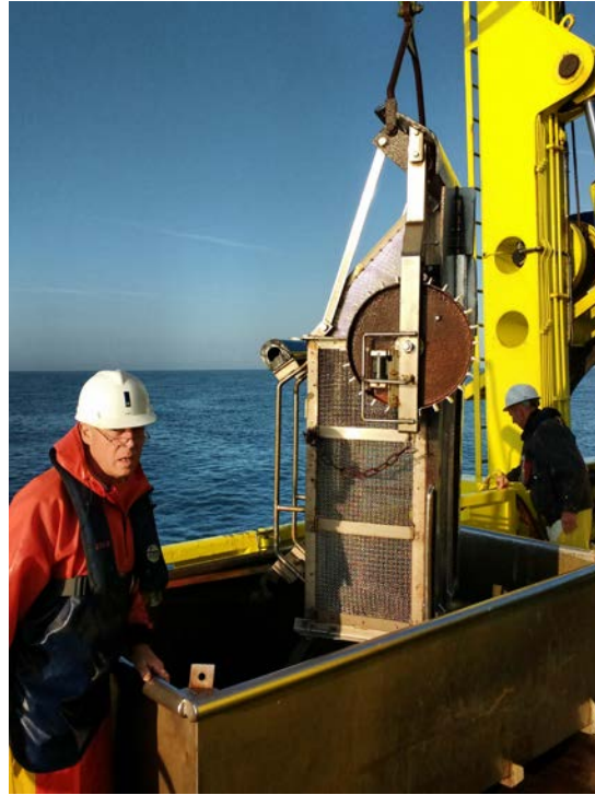
Figuur 3: Bemonstering met de schaaf aan boord van de MS Zirfaea. Te zien is de kooi met een maaswijdte van 5 mm die tijdens het vissen fungeert als zeef. Het telwiel aan de zijkant meet de treklengte (foto Jack Perdon).
